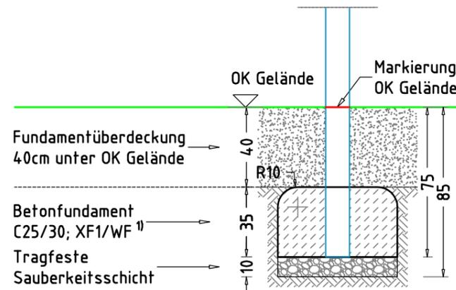
x 1 Betonfundament(e)
