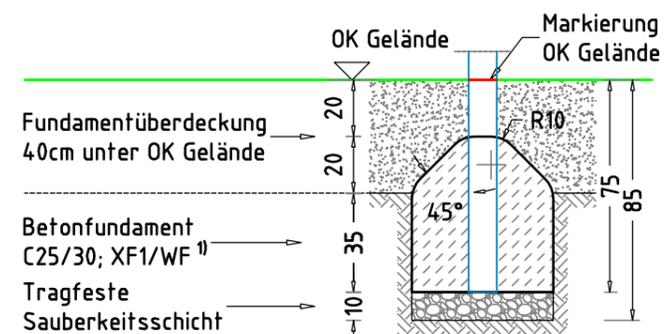
x 4 Betonfundament(e)
