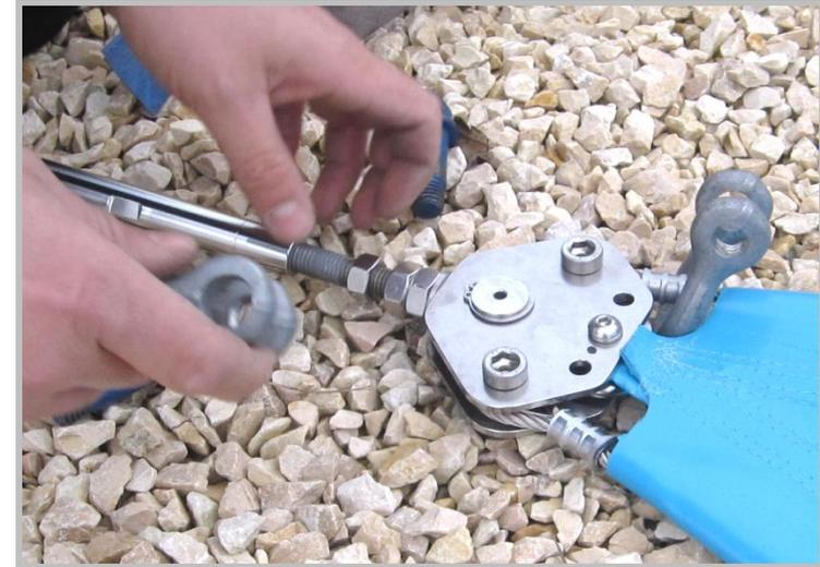
Ab einer Segelgröße von ca. 60 m<sup>2</sup> bzw. einzelnen Kantenlängen ab ca. 10,00 m empfehlen wir den Einsatz eines Kettenzuges. Für das Einhängen des Kettenzuges Schlaufen gemäß Fotos vorbereiten.
